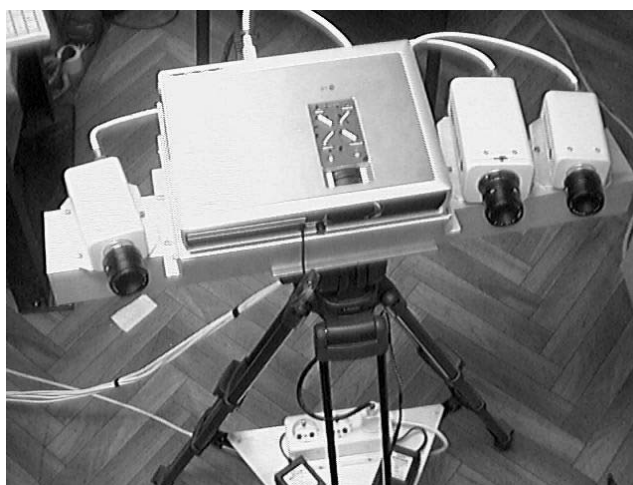
Рисунок 1. Пример 3D сканера. В качестве устройства подсвета применяется мультимедийный проектор, две чёрно-белые камеры служат для получения геометрии, цветная камера нужна для получения текстуры.
